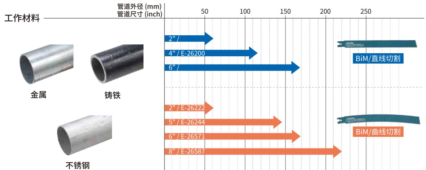
链式台钳往复锯锯条，用于铸铁管
