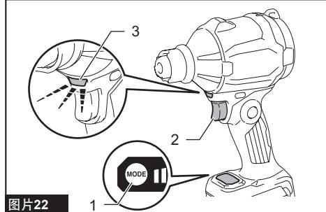
► 1. 风量调节按钮 2. 开关扳机 3. 照明灯
