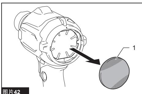
不要拆下吸气口更深处的海绵过滤器A（黄色），它的用途是防止电机受损。
