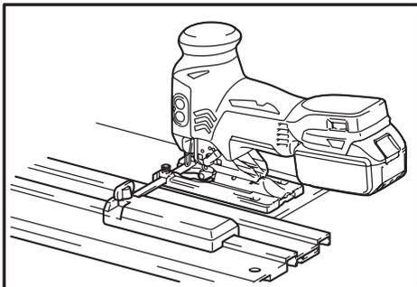
当进行平行等宽切割或直线切割时，使用导轨以及导轨适配器可快速、干净地完成切割。安装导轨适配器时，将刻度杆尽可能地插入基座上的方形孔中。使用六角扳手拧紧螺栓。
