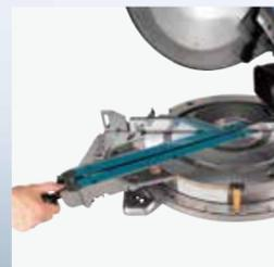
· 由于斜接角度是根据导向栏进行调整的，因此，将刀片与导向栏成直角的新方法可以方便地进行高精度调整
