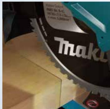
LED灯将锯片的阴影投射到工件上，形成精确的切割线。通过将阴影与工件上的墨线对齐，可以进行精确的切割
