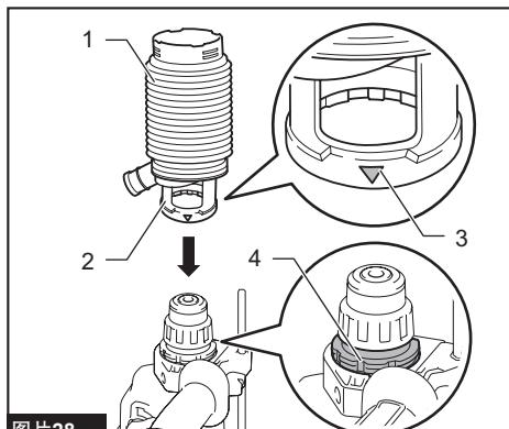
► 1. 集尘杯套件 2. 连接件 3. △ 符号 4. 凹槽
