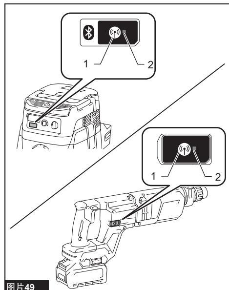
▶ 1. 无线启动按钮 2. 无线启动指示灯
