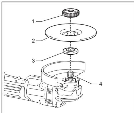
► 1. 使用螺母 (Ezynut) 2. 砂轮 3. 内法兰盘 4. 主轴
