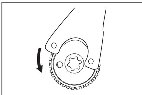
**注：**箭头指向凹槽时可以手动松开使用螺母 (Ezynut)。否则需用锁紧螺母扳手方可松开。将扳手销插入孔内逆时针转动使用螺母 (Ezynut)。
