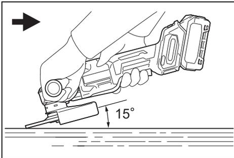
打开工具开关，然后使用砂轮或砂轮片加工工件。通常，砂轮或圆盘边缘应保持与工件表面成  $15^\circ$  角度。
