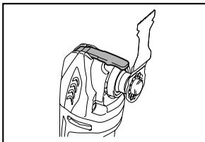
3. 将托座螺栓插入到底。然后将锁定杆恢复至原位。
