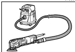
当您想进行清洁剂操作时，请将吸尘器与工具连接。将吸尘器的软管连接至除尘装置（选购附件）。
