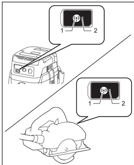
► 1. 无线启动按钮 2. 无线启动指示灯
