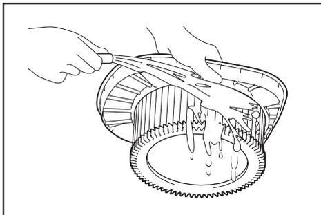
**注：** 请勿用刷子和清洗板等硬物摩擦或刮蹭粉末过滤器、预过滤器或减震器。
