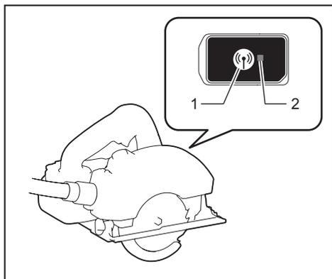
► 1. 无线启动按钮 2. 无线启动指示灯
