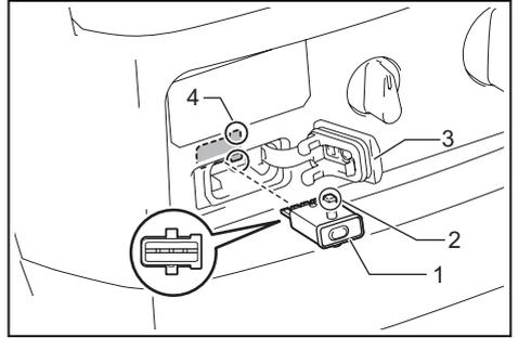
► 1. 无线装置 2. 突起部分 3. 封盖 4. 凹陷部分
