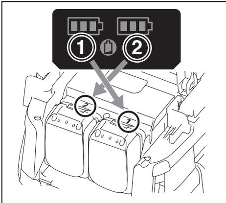
按CHECK（查看）按钮可显示电池剩余电量。各个电池有与之相对应的电池指示灯。
