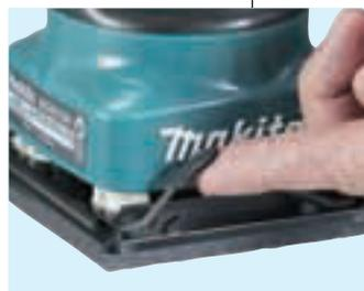
橡胶涂层的砂纸夹杠杆
