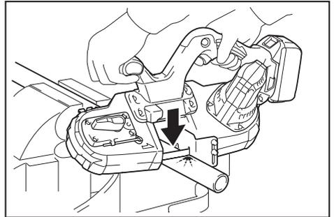
3. 切割快结束时，请释放压力，略微上提，以免工具因工件羁绊而跌落。
