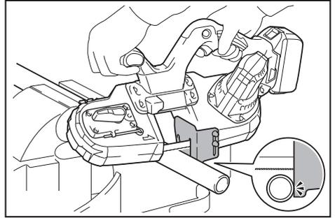
2. 启动工具并等待，直至带锯锯片达到全速运转时再进行操作。轻轻将锯片降低到切口。工具的重量或轻微按压工具即可为切割提供足够的压力。不要强力按压工具。
