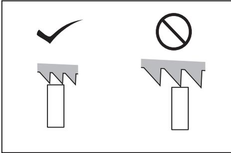
如图所示，将带锯锯片置于工件上合适的切割位置。
