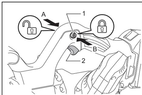
► 1. 扳机锁按钮 2. 开关扳机
