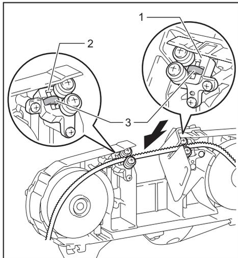
► 1. 下部固定夹 2. 上部固定夹 3. 底部轴承
