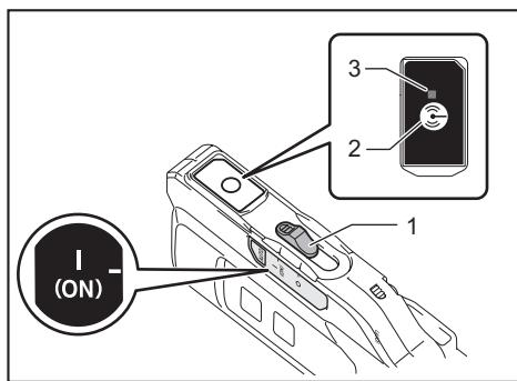
► **1.** 待机开关 **2.** 无线启动按钮 **3.** 无线启动指示灯
