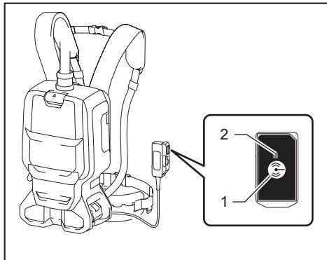
► 1. 无线启动按钮 2. 无线启动指示灯
