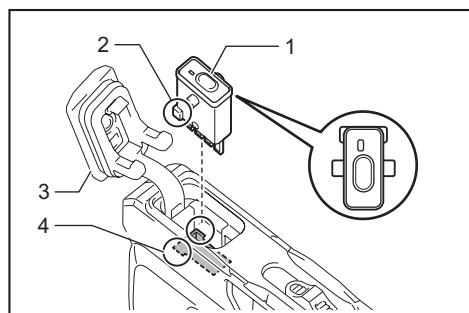
► 1. 无线装置 2. 突起部分 3. 封盖 4. 凹陷部分
