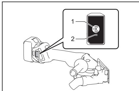
► 1. 无线启动按钮 2. 无线启动指示灯
