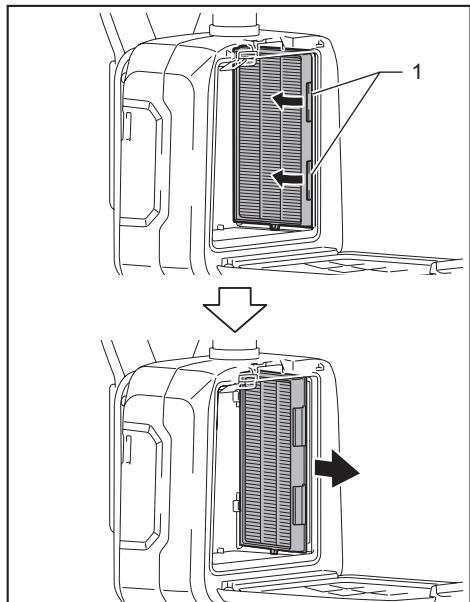
**2.** 拍落过滤器上的灰尘。过滤器可以水洗。每隔 1 至 2 个月清洗一次过滤器上的灰尘和颗粒物。清洗后，为防止产生异味或出现故障，请将过滤器放在通风良好，且无阳光直射的地方完全晾干。
