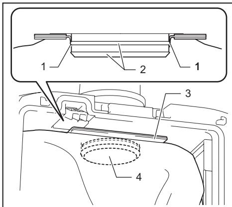
► 1. 过滤袋的橡胶垫 2. 软管接口的边缘
