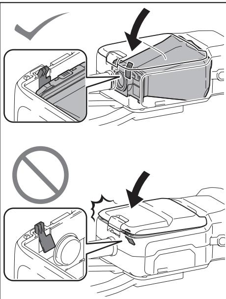
**1. 提起底端以解开扣锁。推动凹槽区以提起锁扣前侧。拉动锁扣以打开扣盖。**
