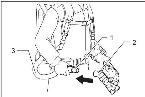
► 1. 前端管口 2. 除尘出气口 3. 软管
