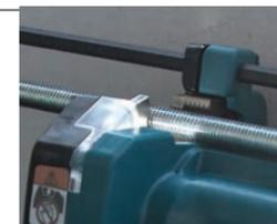
刀片反动停止机构
