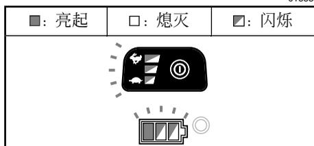
工具过热时，工具将自动停止运转，所有速度指示灯闪烁，且电池指示灯闪烁约 60 秒。在这种情况下，请等待工具冷却后再开启工具。
