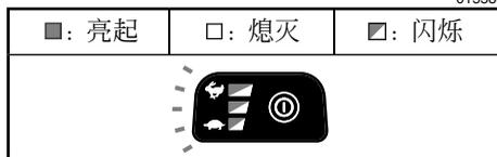
如果因杂草等物导致工具过载，工具会自动停止且所有速度指示灯闪烁。在这种情况下，请关闭工具并停止导致工具过载的应用操作。然后开启工具重新启动。
