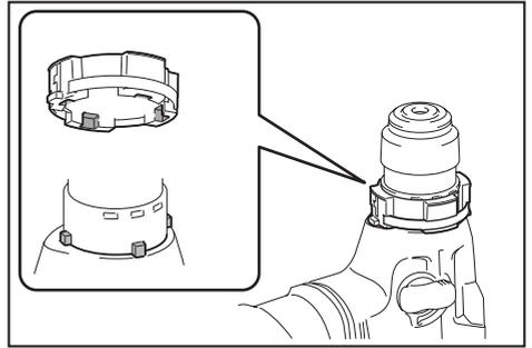
2. 安装侧把手（选购件把手基座组件和从标准侧把手上拆下的把手）时，请将把手上的凹槽扣至衬套上的凸起部分。顺时针旋转把手将其紧固。
