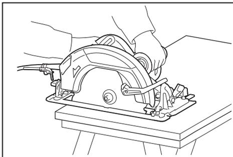
请牢握本工具。本工具具有一个前把手和一个后把手。请同时使用这两个把手以最稳固地把握工具。如果双手握持圆锯，就不会被电动圆锯锯片切割到。将工具基座放在要切割的工件上，电动圆锯锯片不得与工件有任何接触。然后启动工具并等待，直至电动圆锯锯片达到全速运转时再进行操作。现在，您只需在工件表面向前移动本工具，使其平稳地保持平坦前进，直至切锯操作完成即可。
