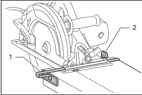
► 1. 切锯导板（导尺） 2. 夹紧螺丝
