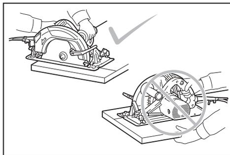
5. 在完成切割后放下工具之前，请确保下部保护罩已关闭，且锯片完全停止。
