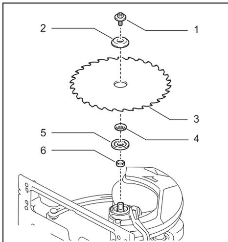
► 1. 六角螺栓 2. 外法兰盘 3. 电动圆锯锯片 4. 挡圈 5. 内法兰盘 6. 主轴环
