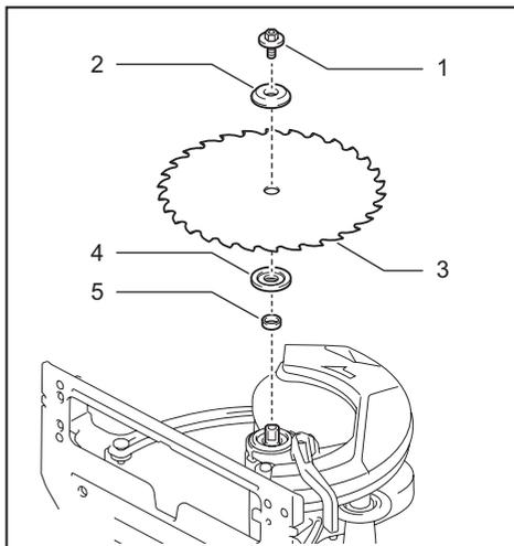
► 1. 六角螺栓 2. 外法兰盘 3. 电动圆锯锯片 4. 内法兰盘 5. 主轴环
