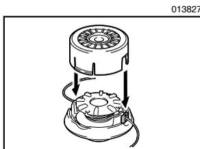
对齐护盖下面的凸起部分和孔眼的槽。然后，用力将护盖推至外罩以将其固定。确保护盖上的插销完全伸出。
