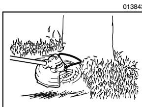
为降低损坏打草头前部物体的风险，可插入钢丝护罩以控制切割线的切割范围。
