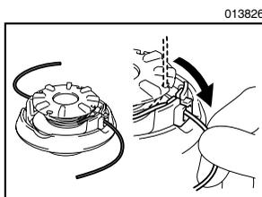
安装线轴至护盖使线轴上的凹槽和凸起部分与护盖上相应部分相啮合。现在，将线头从其暂时固定位置脱开并使尼龙线穿过孔眼以引出护盖外部。
