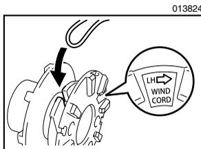
在两条尼龙绳道间，使用线轴中央上的凹口钩住新尼龙线的中央。
