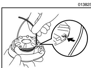
缠绕约剩 100 毫米的尼龙线时，使线头暂时挂在线轴侧的凹口上。
