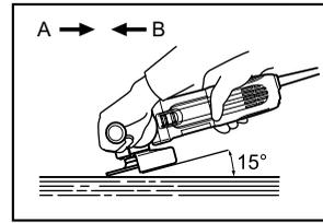
打开工具开关，然后使用砂轮或砂轮片加工工件。
