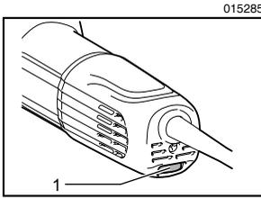
当工具被接通电源时，指示灯呈绿色亮起。如果指示灯没有亮起，则可能是电源线或控制器故障。如果指示灯亮起而工具没有启动（即使工具已开启），则可能是由于碳刷磨损或是控制器、电机或 ON/OFF（开/关）开关故障的缘故。
