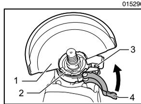
拧松螺丝，然后沿箭头方向拉杆。安装砂轮罩时，将砂轮罩环上的凸缘片对准轴承箱上的槽口。然后根据工件的情况，旋转砂轮罩至可以保护操作者的角度。
