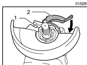
按箭头方向用力拉杆。然后拧紧螺丝以紧固砂轮罩。确保已将螺丝拧紧。砂轮罩的放置角度可通过杆来调节。
