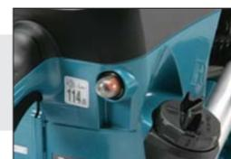
启动泵，无需拉动启动绳即可供给初步的燃油
