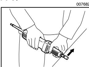
开启工具电源，勿使尖头磨轮与工件有任何接触，然后等待直至尖头磨轮达到全速。接着轻轻地将尖头磨轮抵到工件上。慢慢地向左侧移动工具使之顺利收尾。
