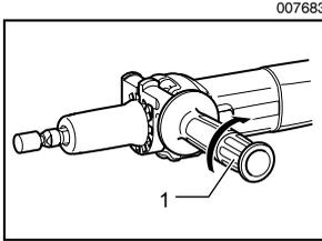
使用侧手柄时，请先取下橡胶保护套，将手柄尽可能深地插入工具的套筒并旋转至所需的角。然后顺时针旋转手柄将其紧固。
