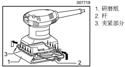
通过升起杆打开研磨纸夹钳，从锁定端松开，然后将研磨纸一端插入夹紧部分，对齐研磨纸边缘，使其平整并与基座的侧边平行。（预先将研磨纸弯曲可使装纸更方便）。一旦研磨纸装入到位，请将杆放回原位。
