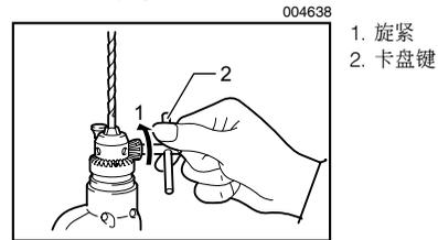
安装钻头时，应将钻头装入卡盘，尽量将其推到底。用手旋紧卡盘。将卡盘键依次放入三个孔中并顺时针旋紧。请务必均匀地旋紧三个卡盘孔。
