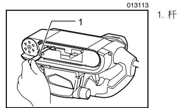
将杆完全拉出并将砂带安装在辊轮上方，然后将杆放回原位置。
