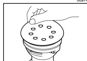
若要安装砂轮片，请先清除垫片上所有的污垢或异物。然后将砂轮片的包装纸撕去，再将砂轮片安装至垫片。请小心将砂轮片上的孔与垫片上的孔对齐。
