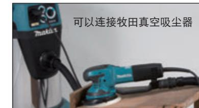
可以连接牧田真空吸尘器
