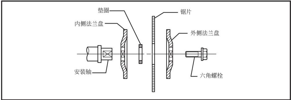
安装法兰盘和六角螺栓，然后按着锁轴，用套口扳手按逆时针方向完全拧紧六角螺栓，然后按顺时针方向调整六角螺栓，以扣紧中心盖。
