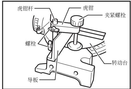
如果某些部件接触到虎钳时，要重新调节虎钳臂的位置。用力下压工件使它与导板和转动台紧贴在一起。然后将工件放置在所要切割的位置并紧固虎钳夹紧螺钉来牢固地加以固定。
