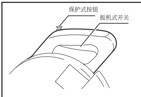
为避免意外扣动扳机，本工具备有保护式开关。开机时，可将手柄推至左侧，按下保护式按钮，然后扣动扳机。松开扳机则可关机。
