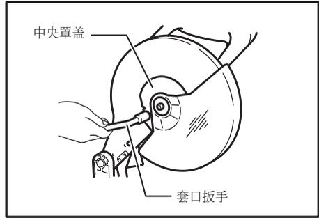
卸锯片时，首先要松开处于最低位置的手柄。按动轴的锁定装置，使锯片不能旋转，再使用套口扳手去松开六角螺栓。然后取下六角螺栓、外法兰盘以及锯片。
