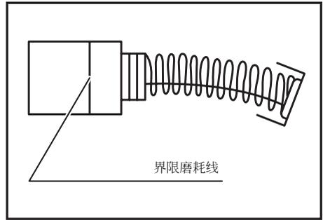
用螺丝起子取下碳刷夹盖子。取出磨损的碳刷，插进新的碳刷，然后拧紧碳刷夹盖子。
