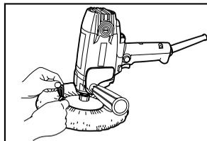
用羊毛抛光球包住橡胶垫，然后拉紧线绳。打一个蝴蝶结，然后将蝴蝶结和松散的线绳都塞在羊毛抛光球和橡胶垫之间。
