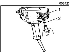
用螺丝起子拆下碳刷夹盖。取出已磨损的碳刷，插入新的碳刷，然后紧固碳刷夹盖。
