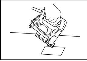
如果您细心的按下述方式操作，就没有必要钻开始孔或进行诱导切割。
